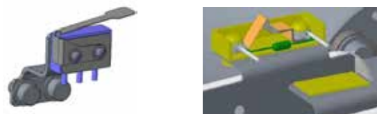
(a)マイクロスイッチ (b)開発した展開モニタ
