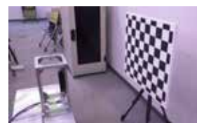
図8 CMRD2地上予備品を用いたキャリブレーション
